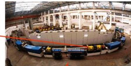
兰州重离子加速器冷却储存环
