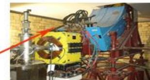
重离子加速器 (SSC) 注入到主环 (CSRm) 接口的脉冲四极透镜
